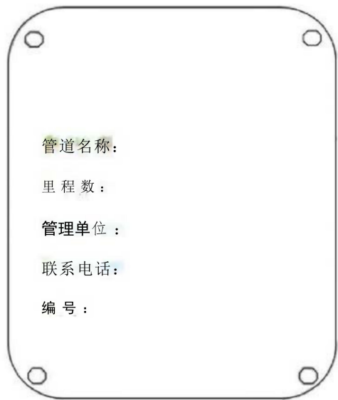
图 A.4 高桩里程桩铭牌
